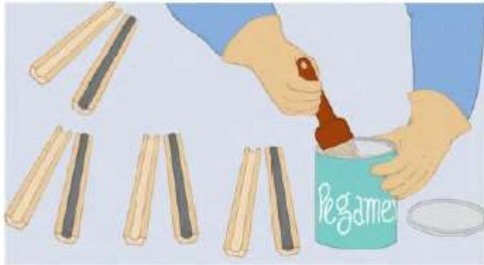
La madera se corta en tablillas delgadas, en ellas se hacen pequeñas ranuras para colocar las minas, después se les agrega pegamento y quedan como un sándwich.
