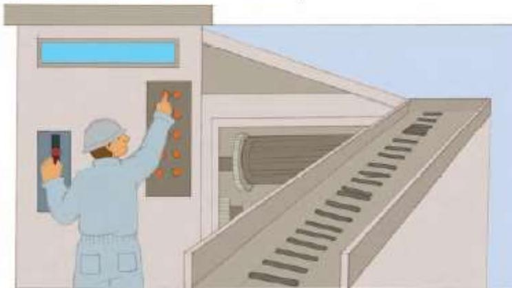
La arcilla se mezcla con el carbón en las máquinas y de esa masa se obtienen las minas.
