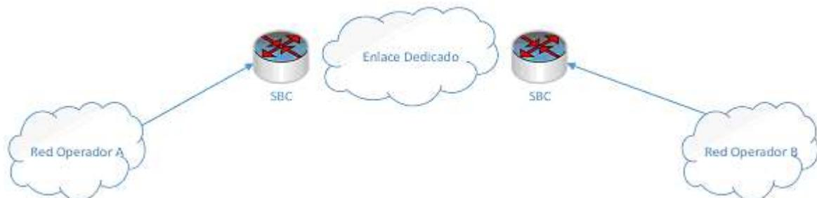
Figura 1: Topología de interconexión SBC-SBC
